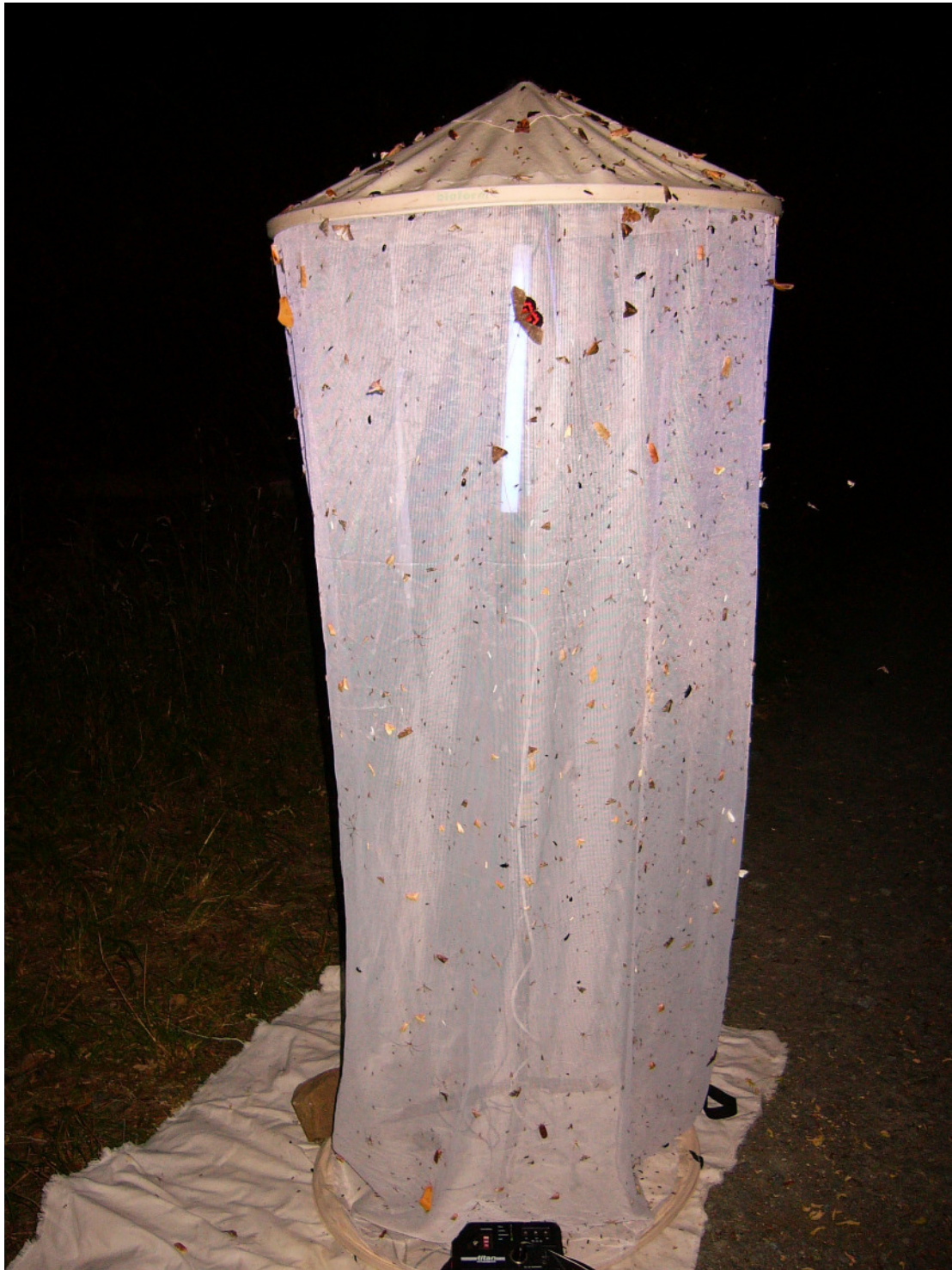
Bild 1 Als die wichtigste Nachweismethode zur Erfassung von nachtaktiven Schmetterlingen gilt der Lichtfang. Als Leuchtquelle diente eine 15-Watt superaktinische Leuchtstoffröhre. Der hohe UV-Anteil der Leuchtstoffröhre wirkt besonders anziehend auf Insektenaugen. Die Falter setzen sich überwiegend an die weiße Gaze und können dann problemlos bestimmt werden
